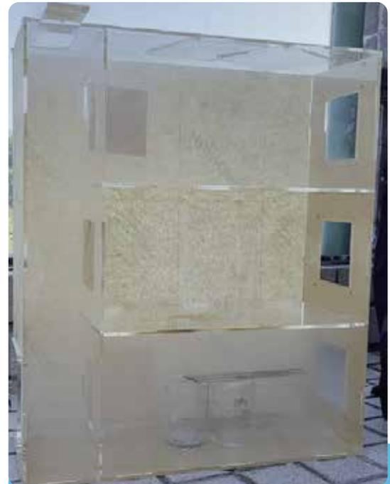
教大團隊特製的三層膠箱模型，模擬樓宇發生火災的情境及觀察濃煙的流動
