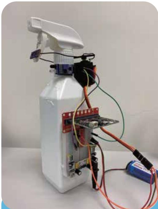
由 micro:bit、紅外線感應器、MG995 伺服馬達、噴壺及其他電源配件組成的自動洗手液機\*
