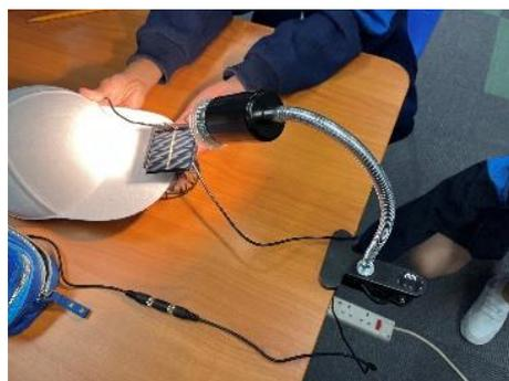
能量值實驗：學生利用太陽燈充當陽光，小心地測試怎樣的擺放角度，才能製造最多的能量。
