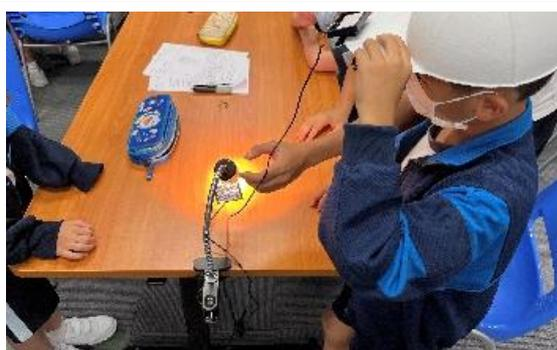
能量值實驗：學生利用太陽燈充當陽光，利用面積比較小的太陽能電池板，從而自行發現不同大小的太陽能電池板與能量值輸出的關係。
