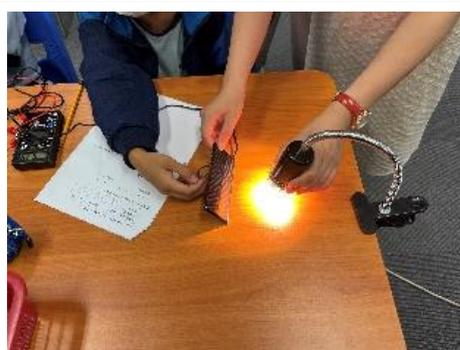
能量值實驗：學生利用太陽燈充當陽光，利用面積比較大的太陽能電池板，自行發現不同面積的太陽能電池板與能量值輸出的關係。
